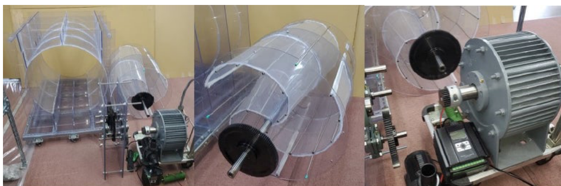
組立前の主要システム部品全体 70φcmワープタービンブレード 三相20kWh 48V 200rpm 発電機
